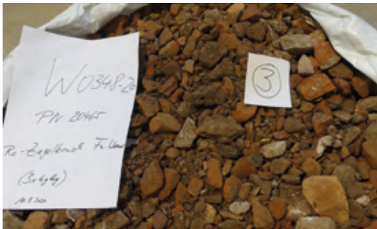
Abb. 2: Als Ausgangsmaterial verwendeter Mauerwerkbruch eines Recyclingunternehmens
