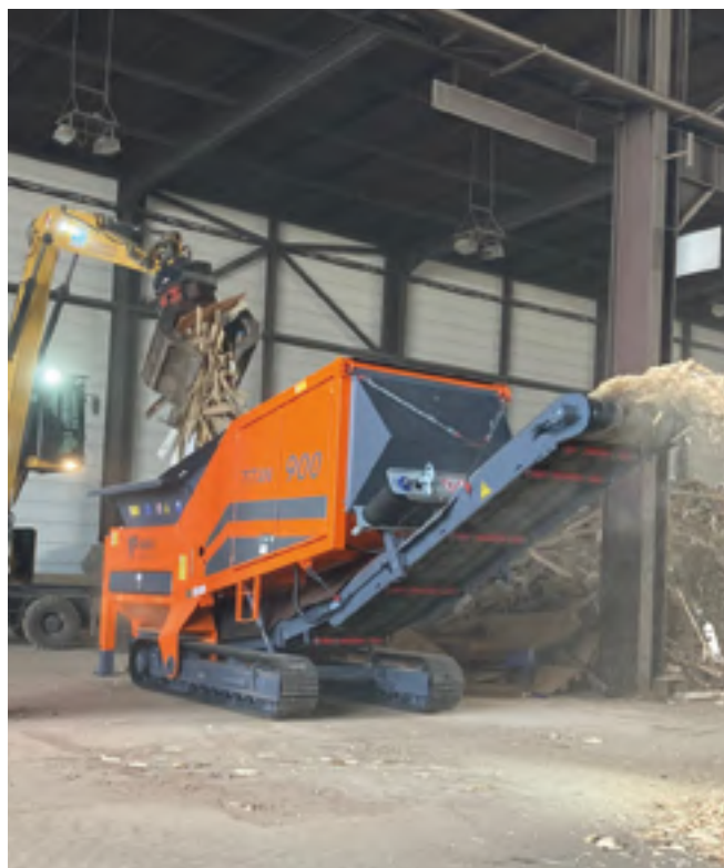
Ohne Umrüstung verarbeitet der ARJES Titan 900 bis zu 200 t/h Altholz, Foto: © Moerschen
