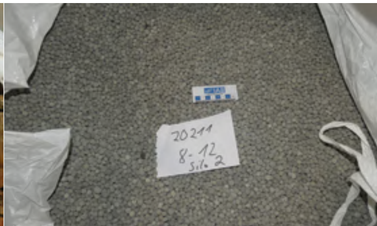
Abb. 3: Im Drehrohrföfen erzeugte leichte Gesteinskörnungen für die Werksversuche
