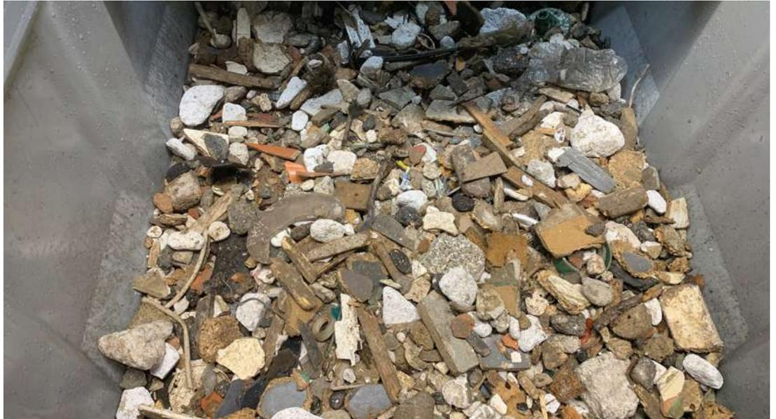
Inputmaterial: Bauschutt versetzt mit Holz, Kunststoff, Leichtbausteine, Ytong, Pappe, Draht
