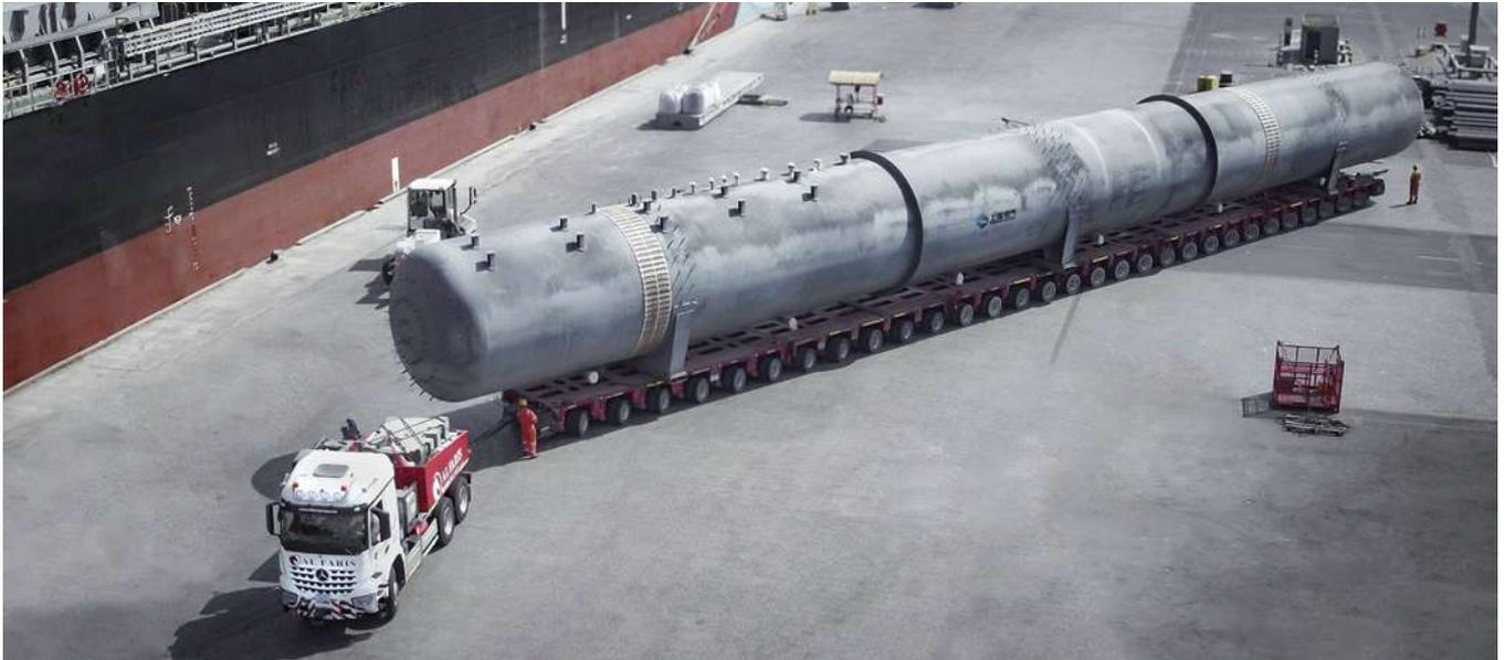
Für die Beförderung und den Aufbau von 30 Tanks für den weltweit größten Solarpark in den Vereinigten Arabischen Emiraten vertraute das beauftragte Transport-Unternehmen erneut seinen bewährten Goldhofer-Schwerlastmodulen vom Typ THP/SL. Um die je 52 Meter langen und 235 Tonnen schweren Ladungen zuverlässig über die circa 90 Kilometer lange Strecke zu bewegen, waren aufwändige logistische Vorarbeiten und Genehmigungen notwendig.
